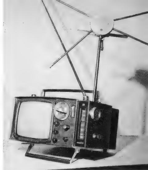
Bild 1. Sony-Micro-TV 5-303 E mit rechts ange-setztem UHF-Konverter und VHF- bzw. UHF-Antenne
