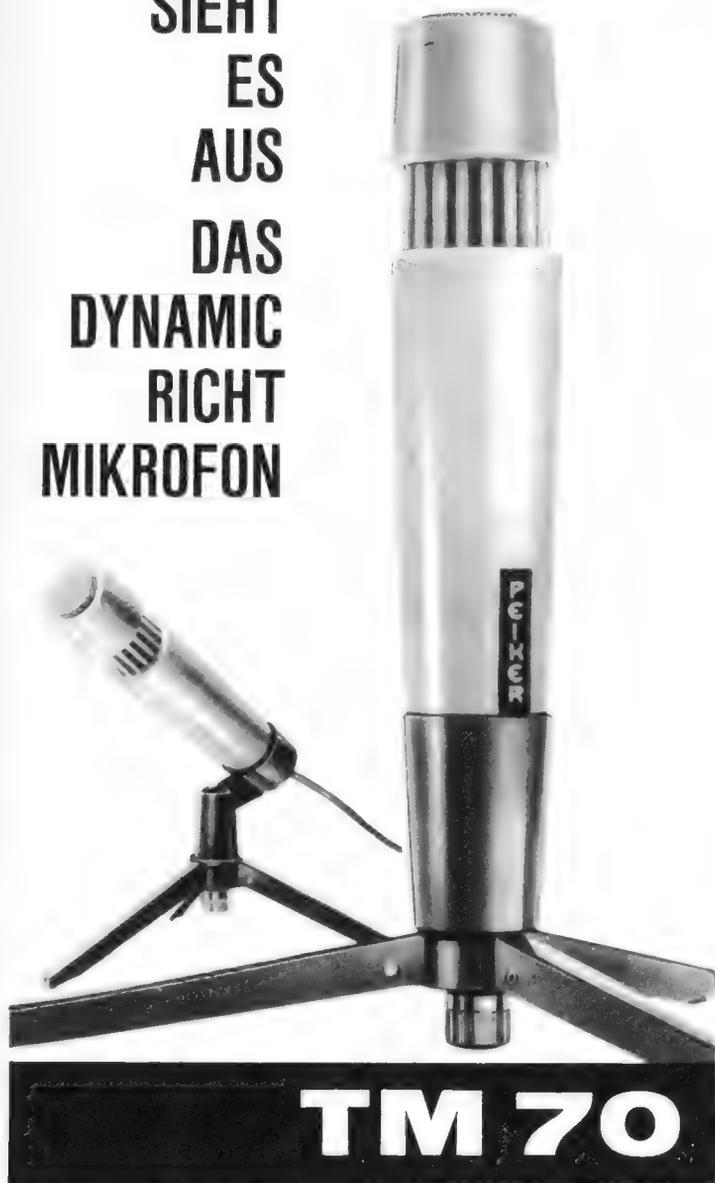
10000fach erprobt und bewährt, stabil und zuverlässig, ausgereifte Technik, hohe Leistung, universelle Anwendung, Frequenzumfang: ca. 70-13 000 Hz  $\pm$  3 dB, Empfindlichkeit: 0,22 mV/mikrobar an 200 Ohm, Richtcharakteristik: nierenförmig, mit leichtem Klapp-Stativ (20 g), ein Mikrofon für alle, die viel erwarten.
